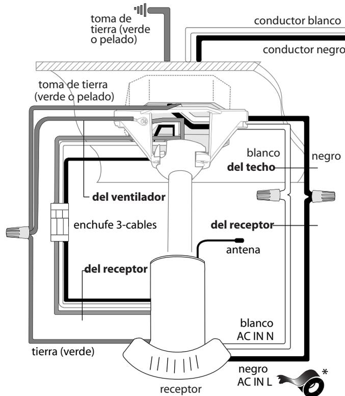
\* Como una medida de seguridad adicional, envolver cada conector para cable por separado con cinta aisladora.
